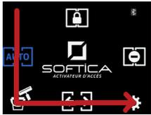
Dessin d'un L pour verrouiller et déverrouiller l'écran.
